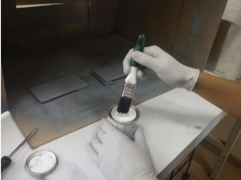
Imagen 3. Recubrimiento de placas de acero al carbono A-36
