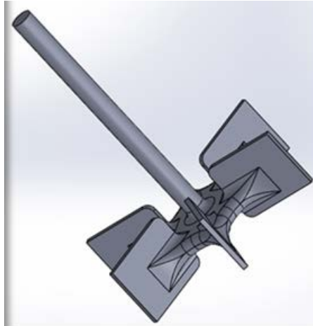
Figura 2. Agitador tipo turbina de seis palas
