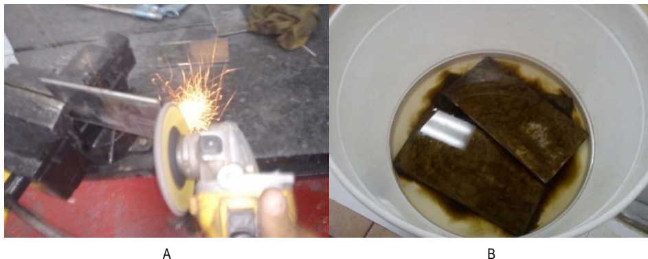
Imagen 2. A, preparación de especímenes para pruebas de inmersión en agua de mar; B, decapado en \text{HNO}_3 0.1 N
